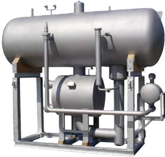
Два испарителя серии SPW-55 с хладагентом R507 соединяются параллельно с сепаратором. Установка для лаборатории имитации климатических условий в автомобильной промышленности.
